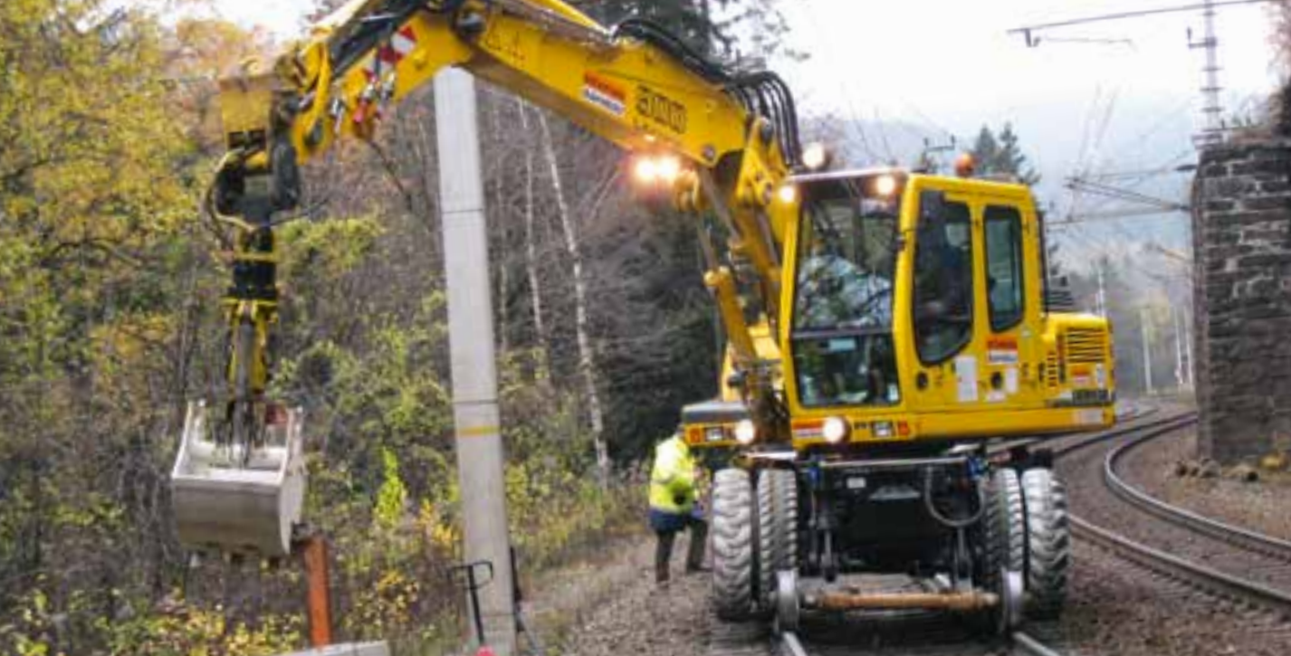
Caricatore idraulico ibrido all'opera
